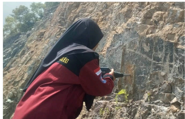
Gambar 3 Kegiatan pengukuran nilai pantulan menggunakan Schmidt Hammer tipe N pada singkapan batupasir Formasi Meluhu
