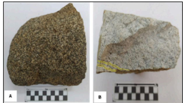
Gambar 5 A. sampel ST-10 teralterasi lemah dan B. sampel ST-4 teralterasi kuat
