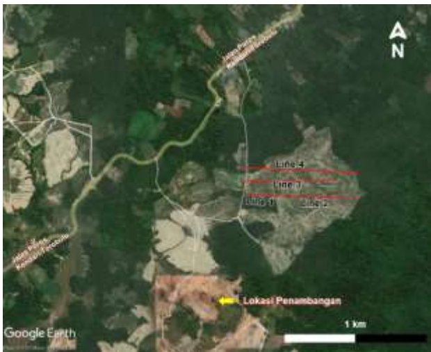
Gambar 4 Orientasi lintasan pengukuran ERT. Garis merah menunjukkan lintasan pengukuran
